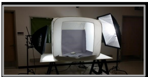
Fig.1.4- Iluminación de un objeto durante el escaneo
